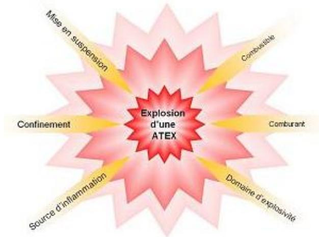
L'explosion en espace clos ou à l'air libre : il s'agit de l'explosion d'une ATEX (ATmosphère EXplosive) formée par un mélange dans des proportions spécifiques entre l'air et le méthane du biogaz. Une source d'inflammation doit être présente. L'explosion engendre des effets thermiques et mécaniques (surpression).
